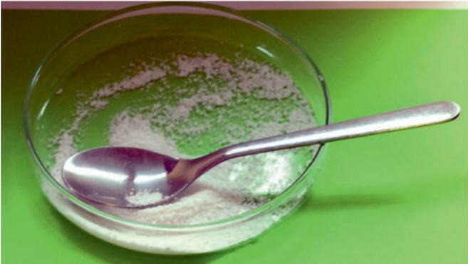
Das Gemisch aus Zitronensäure und Backpulver führt nicht zu einer Reaktion. Das im Backpulver enthaltene Natriumhydrogencarbonat ist der Reaktionspartner der Zitronensäure.
