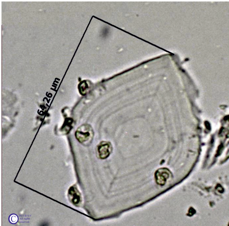
durch Methylbenzol deadsorbiertes Kristall mit sichtbaren Gefügeschichten
