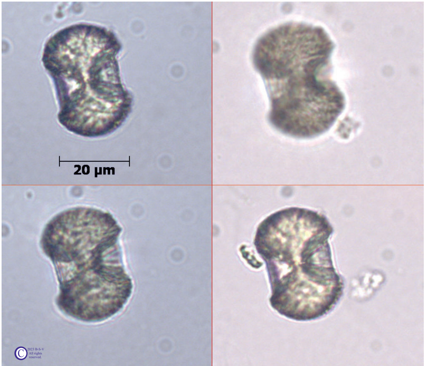
hantelförmige Gestalt des Monohydratzustandes
